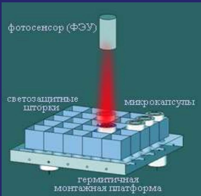
Общий вид эскизного варианта автоматической биологической лаборатории. Видны: герметичная монтажная платформа с каналами сообщения между микрокапсулами общей площадью 60×60мм<sup>2</sup>; несколько микрокапсул, включающими микрокапсулы инкубаторов для микроорганизмов, источников воды, газовой среды и т.д.; датчиков давления, температуры и т.д.; клапанов сброса давления; фотосенсора. На этом рисунке также показан луч красного флуоресцентного излучения микроорганизмов из инкубатора.
